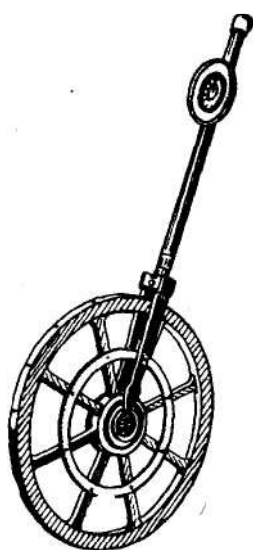
Рис. 21. Эвристический прием аналогии отношений путем масштабного копирования технического объекта: измеритель пути Фернеля 1552 г. как прототип курвиметра.
